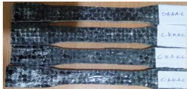
Fig.2 Tensile test specimen
